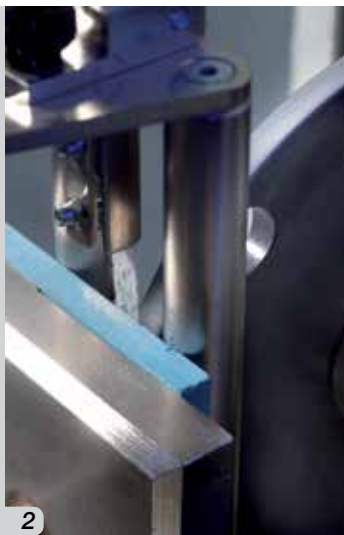
Фигури 1_2 - Изпитване за измерване на устойчивостта на абразия (износване) Фигура 3 - Проверка на стабилността на образец от фугираща смес на циментова основа
