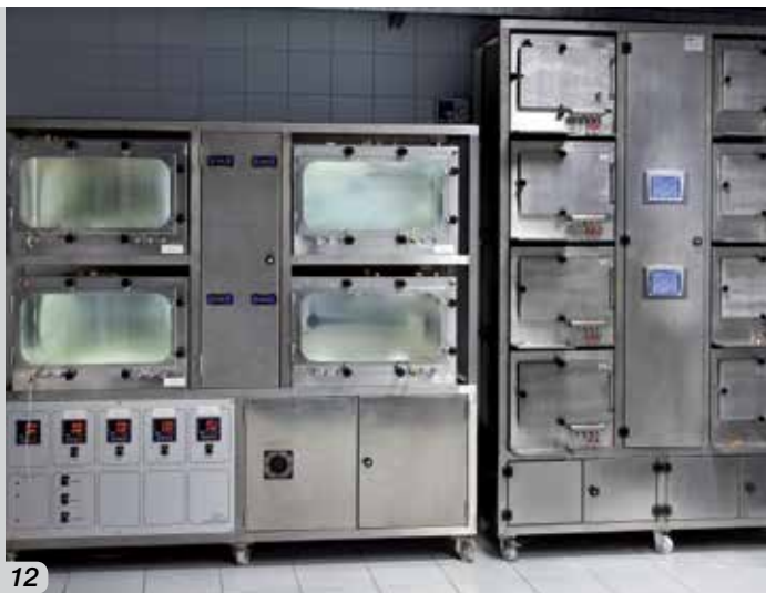
Фигура 12 – Камери за симулация на околната среда, налични в научнопроучвателната лаборатория на Мареі Фигури 13_14 - Изпитване за измерване на емисиите на ЛОС
