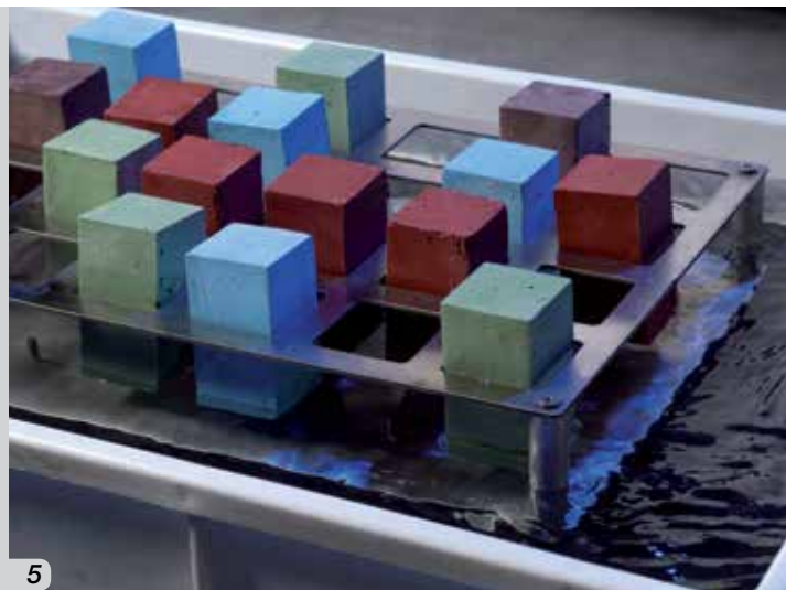
Фигура 4 - Изпитване за измерване на якостта на огъване на образец от фугираща смес на циментова основа Фигура 5 - Изпитване за абсорбция на вода
