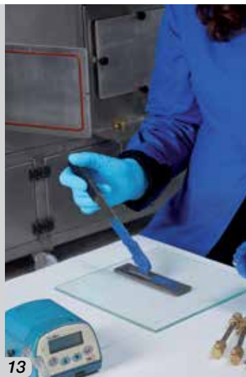
Фигура 12 – Камери за симулация на околната среда, налични в научнопроучвателната лаборатория на Мареі Фигури 13_14 - Изпитване за измерване на емисиите на ЛОС
