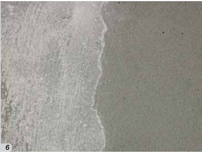
Фигура 6 - Повърхност на фугираща смес на циментова основа с ефлоресценция
