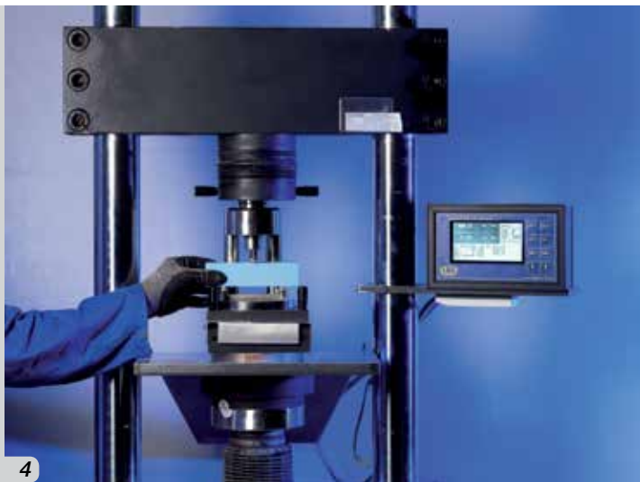
Фигура 4 - Изпитване за измерване на якостта на огъване на образец от фугираща смес на циментова основа Фигура 5 - Изпитване за абсорбция на вода
