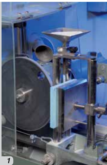
Фигури 1_2 - Изпитване за измерване на устойчивостта на абразия (износване) Фигура 3 - Проверка на стабилността на образец от фугираща смес на циментова основа
